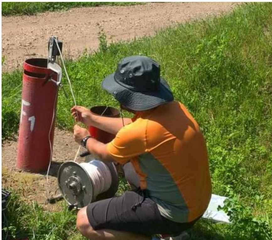
Fig. 9.8 Măsurarea nivelului piezometric
