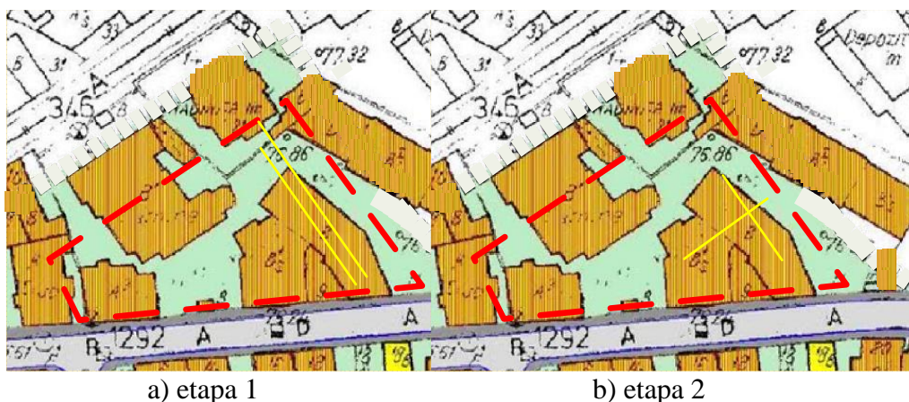
Fig. 5.2: Dispunerea profilurilor de investigație electrică în cele două etape de achiziție
