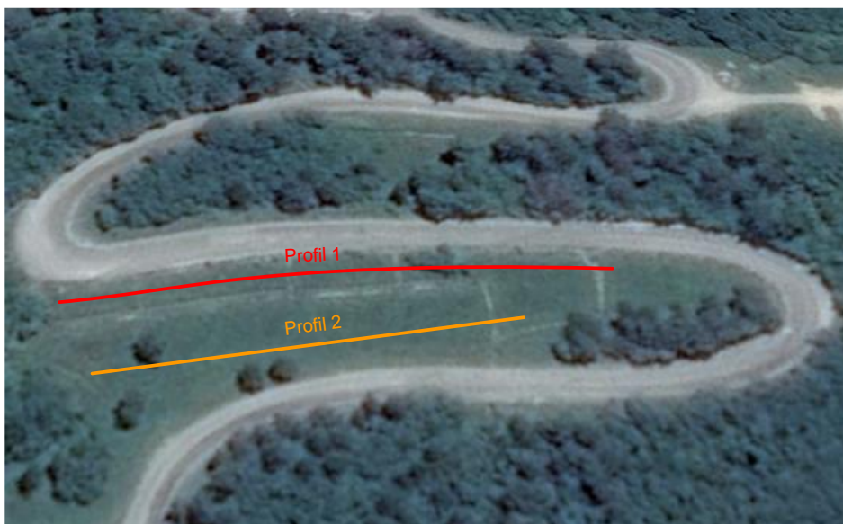
Fig. 7.19 Poziția profilurilor realizate în zona afectată de fenomenele de instabilitate
