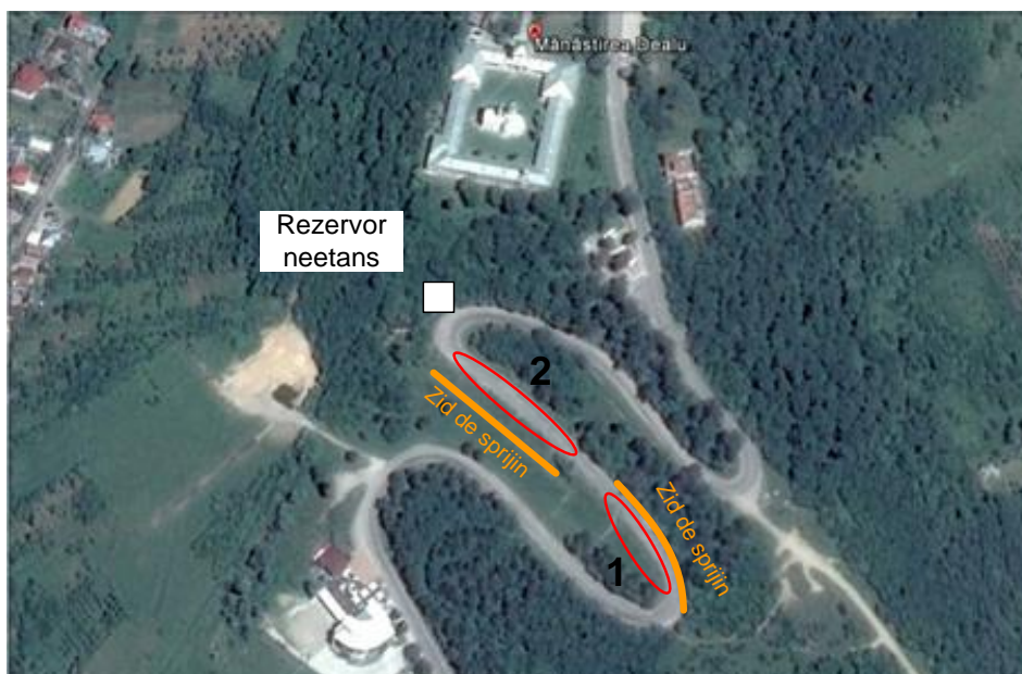
Fig. 7.5 Porțiuni ale drumului afectate de alunecări de teren
