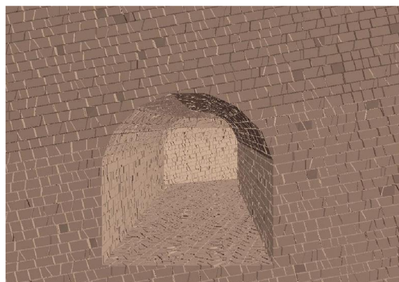
Fig. IV.53: Geologia generată aleatoriu din vecinătatea unei secțiuni de tunel [137]
