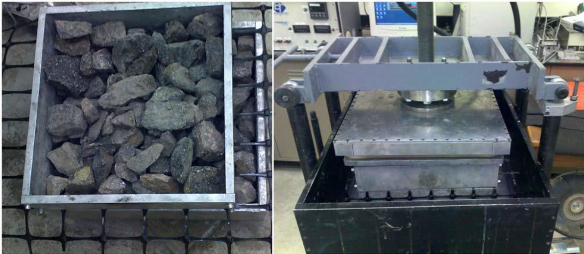
Fig. IV.38: Configurația încercării de forfecare în caseta de mari dimensiuni [110]
