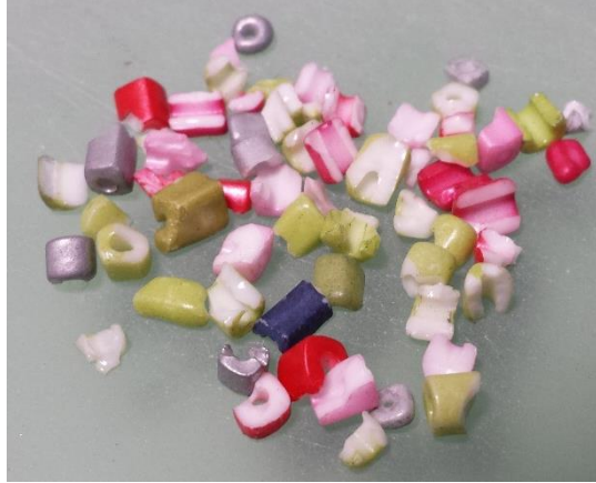
Fig. VI.65: Exemplu de particule sparte în urma încercărilor de forfecare directă
