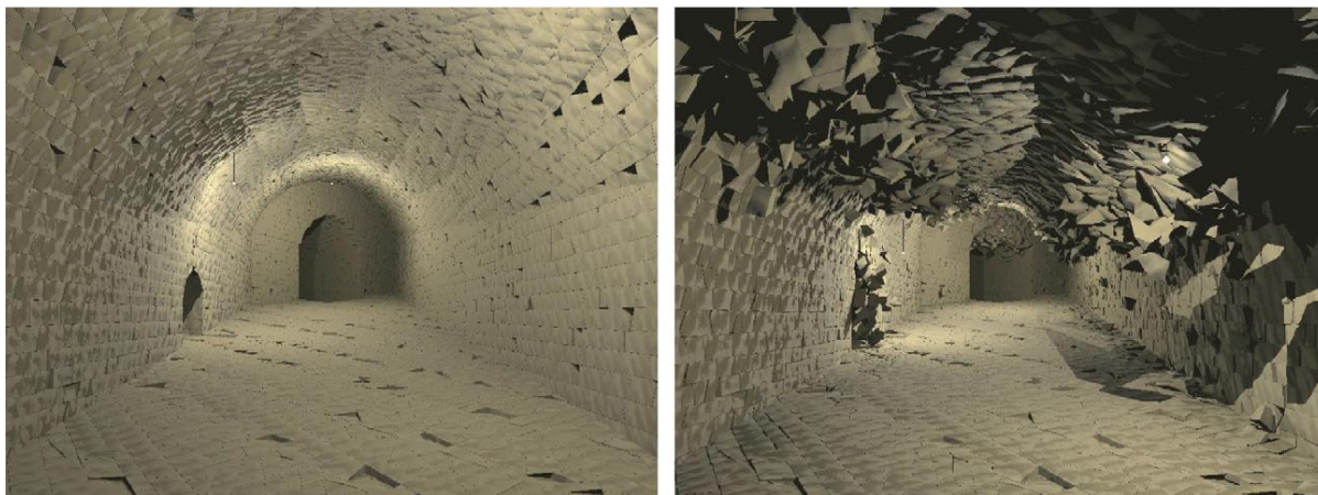
Fig. IV.54: Rularea modelului în care se produce cedarea [137]
